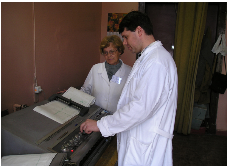
Один из первых ЯМР спектрометров Perkin Elmer R12 (выпуск 1969 г.): Г. М. Фролова, Р. Е. Трифонов
