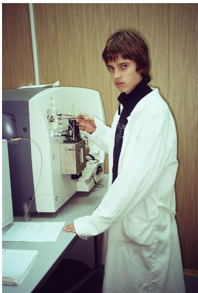
Лабораторная работа со школьником 11 класса на хромато-масс-спектрометре LCT-Premier, 2011 г.
